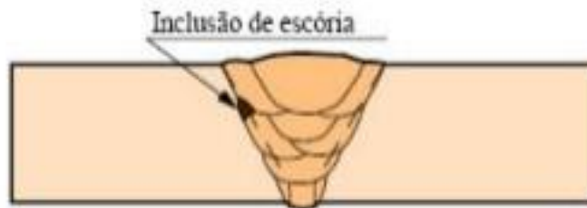
Figura 7 – Inclusão de escória em cordão multipasse
