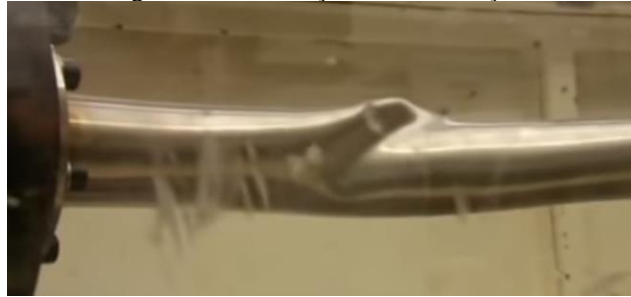
Figura 6 - Deformação do eixo de aço
