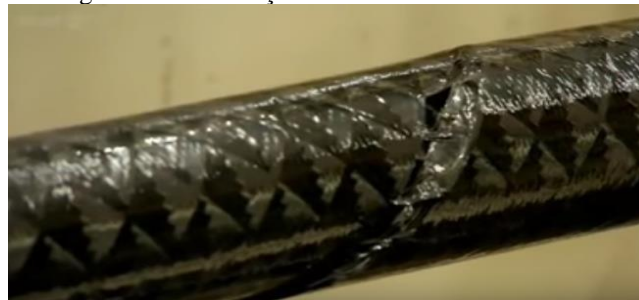
Figura 7 - Deformação do eixo de fibra de carbono
