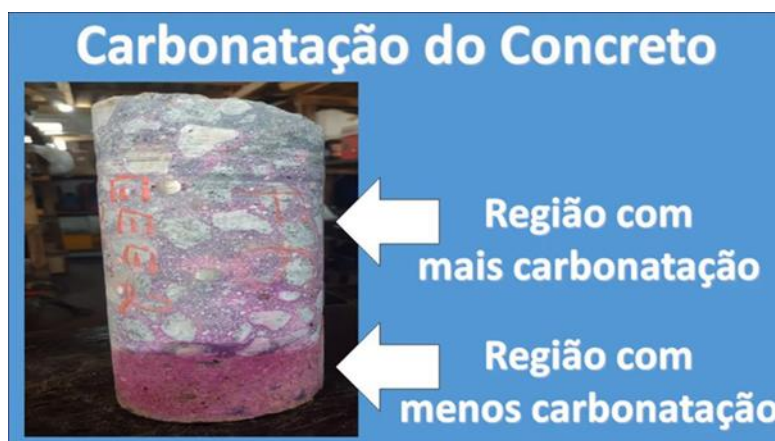
Figura 1: Corpo de prova apresentando frente carbonatada.
