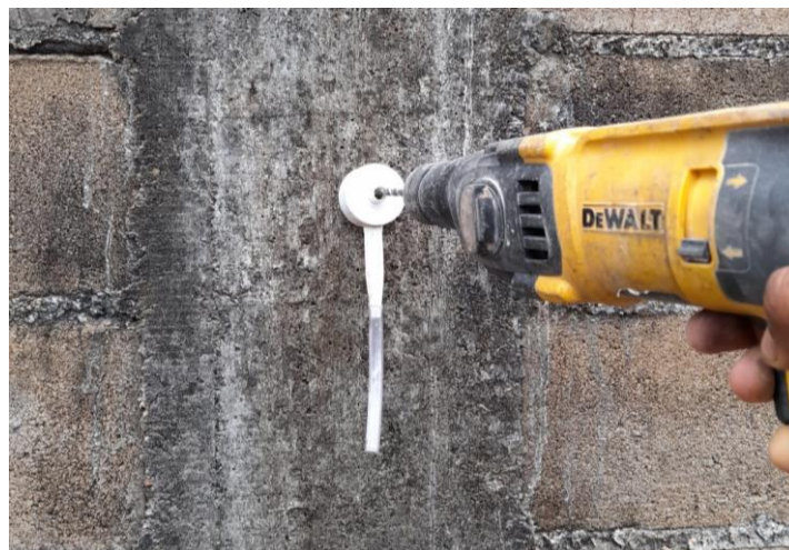
Figura 5: Realização da perfuração em uma estrutura de concreto utilizando o Método II de ensaio.
