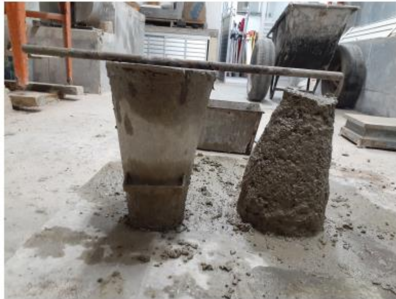
Figura 1 – Abatimento do concreto
