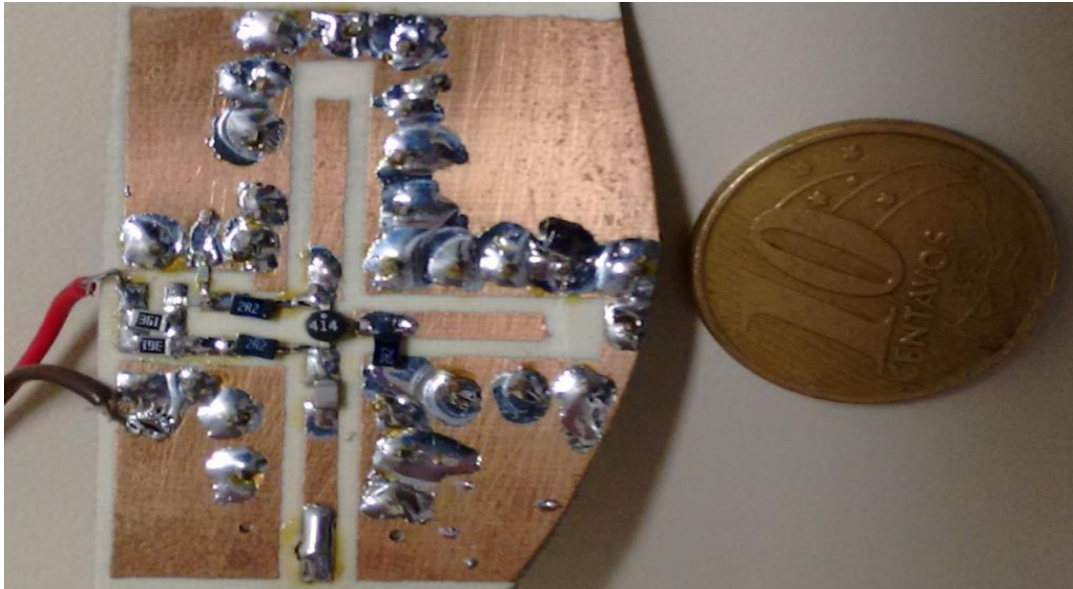
Figura 21: Circuito oscilador de 4GHz com linhas Microstrip .
