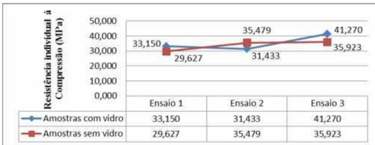
Gráfico 1 - Resultado dos ensaios de compressão (MPa).
