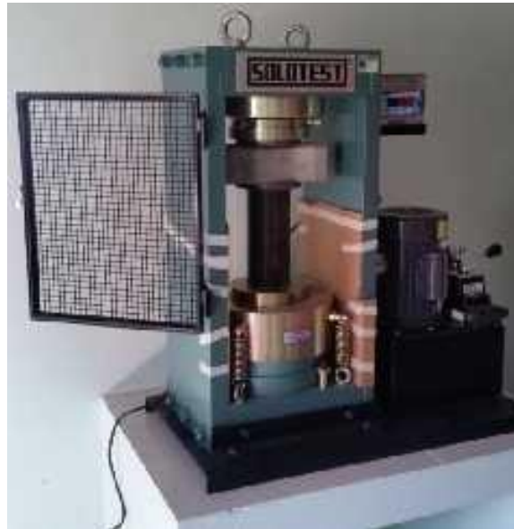
Figura 9 - Prensa eletrohidráulica digital SOLOTEST (100 tf, 220V - 60Hz) Modelo: 1.501.220.
