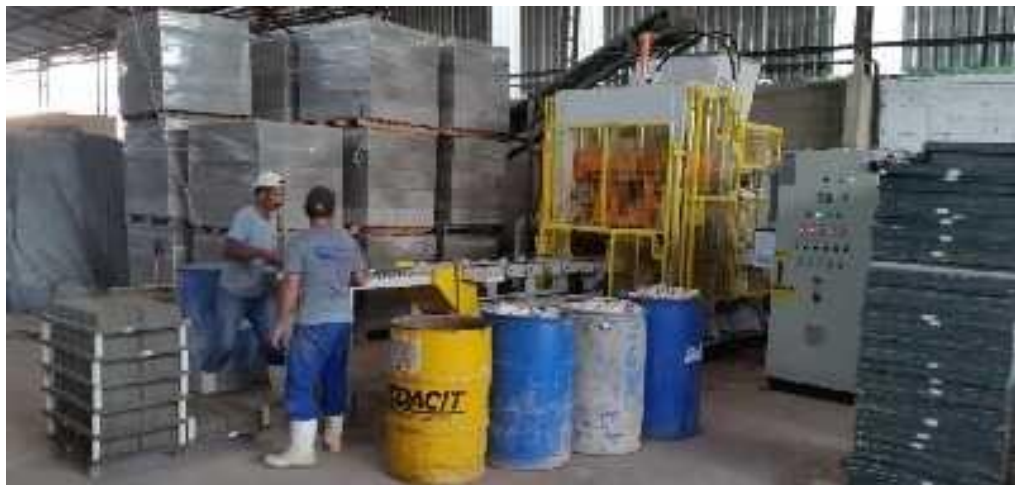
Figura 7 – Máquina Vibro-prensa hidráulica automática.
