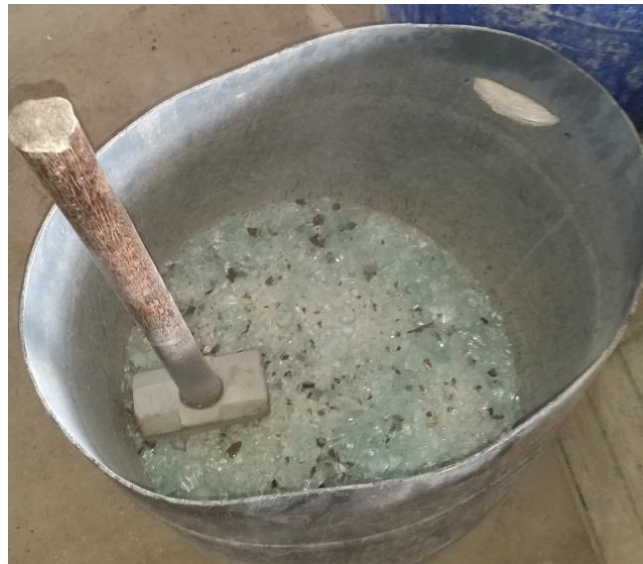
Figura 5 – Resíduos de vidro (Provenientes de vidraçaria e garrafas), sendo triturados por marreta.
