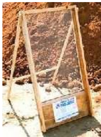
Figura 1 – Peneira utilizada, modelo “Ciranda”.
