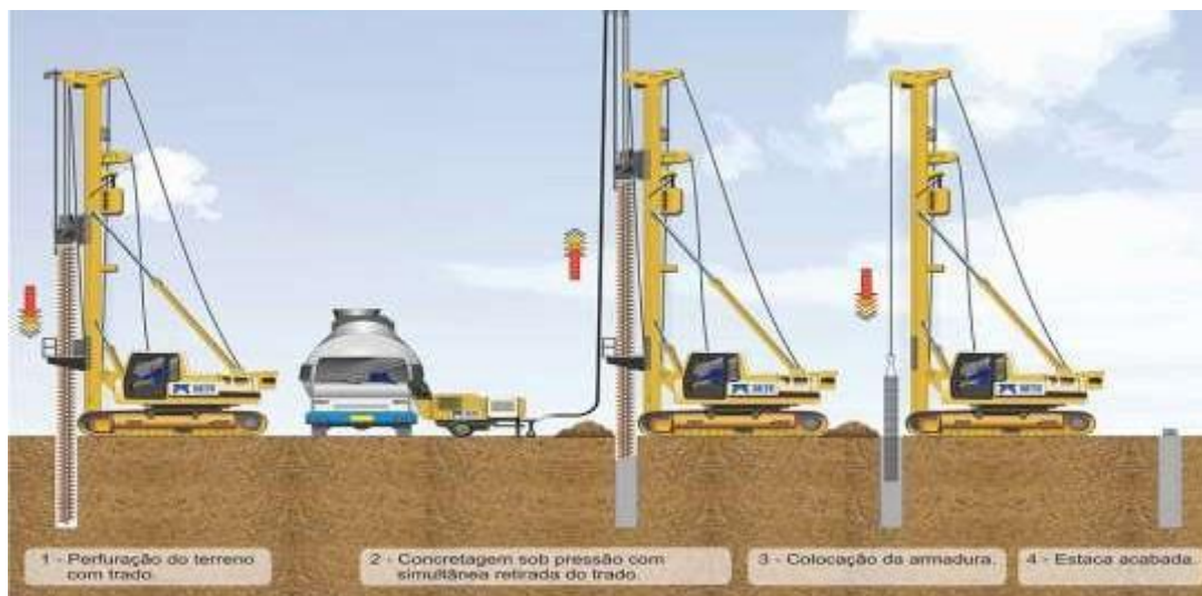
Figura 1: Fases de Execução da Estaca Hélice Contínua.
