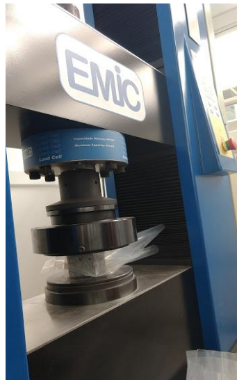
Figura 20 – Máquina Universal EMIC DL 60000 utilizada no ensaio de compressão uniaxial
