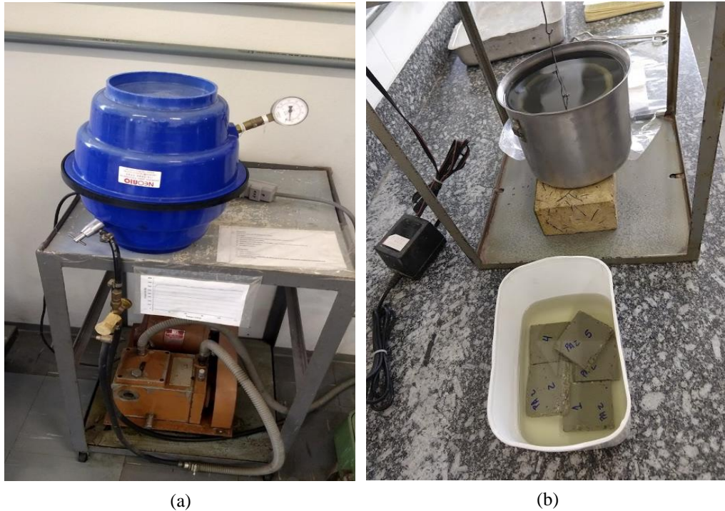
Figura 18 – (a) Bomba de vácuo e (b) aparato metálico utilizados no ensaio de PA e DA
