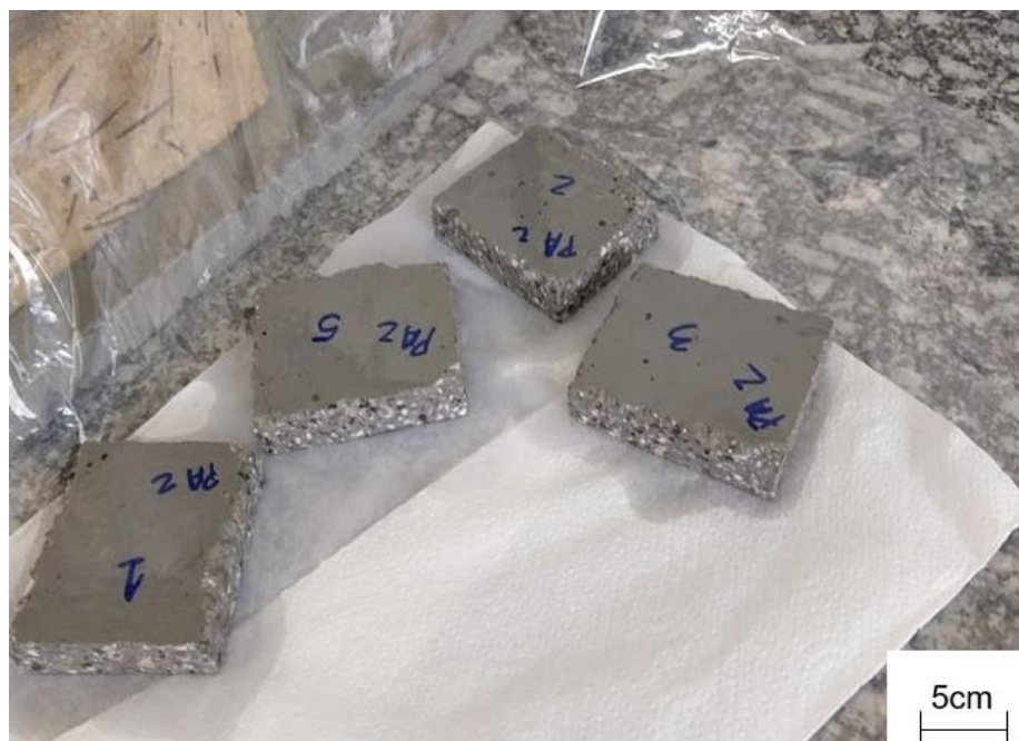
Figura 17 – Corpos de prova obtidos a partir dos tijolos para o ensaio de PA e DA
