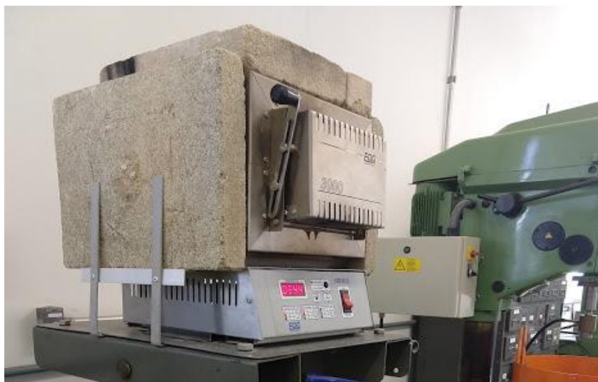
Figura 24 – Forno utilizado para aquecer as amostras durante o ensaio
