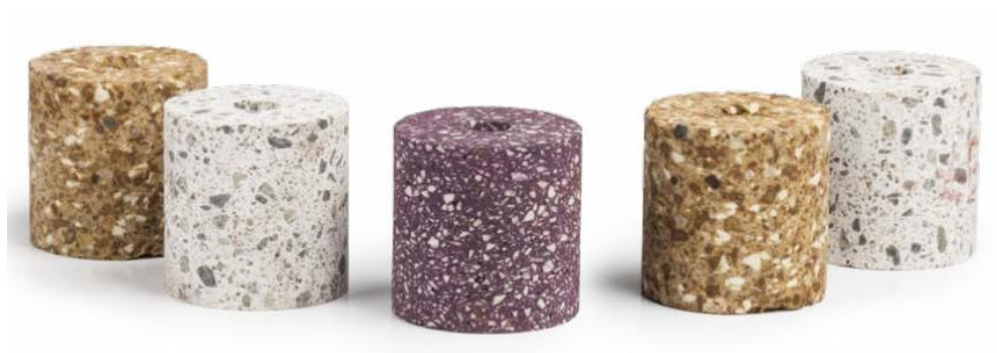
Figura 8 – Exemplo de amostras cilíndricas utilizadas nos ensaios de RSC
