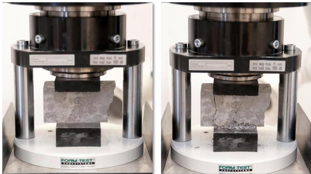
Figura 4 – Exemplo de amostra de refratário submetida ao ensaio de RCTA: (a) início e (b) fim do teste, com a ruptura do corpo de prova.
