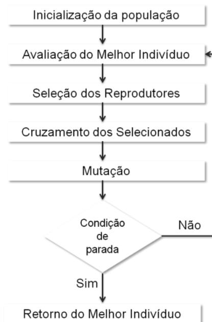
Figura 1 – Fluxograma do Algoritmo Genético
