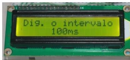
**Figura 6:** Display com ajuste de intervalo de tempo.
