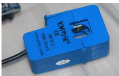
**Figura 7:** Sensor de corrente de 100 A.
