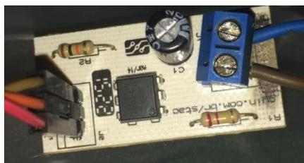
**Figura 8:** Sensor de tensão.
