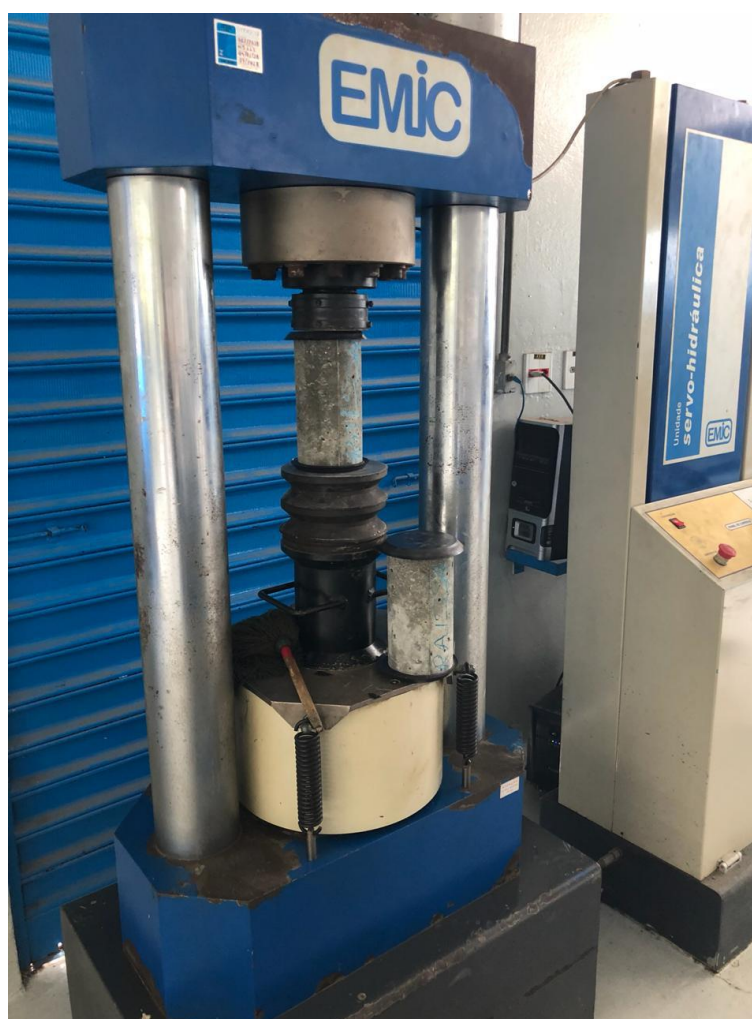
Figura 12 – Rompimento dos Corpos de Prova. Fonte: Autoria Própria, 2018.
