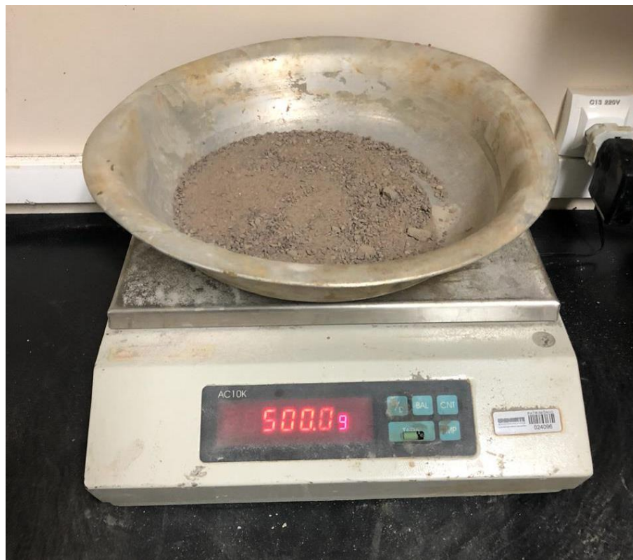
Figura 2 – Pesagem da Amostra do Pó de Pedra. Fonte: Autoria Própria, 2018.
