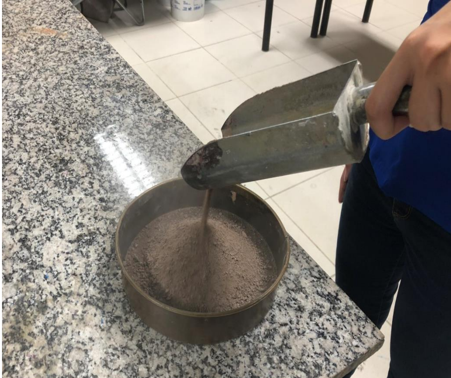
Figura 4 - Ensaio de Massa Unitária. Fonte: Autoria Própria, 2018.
