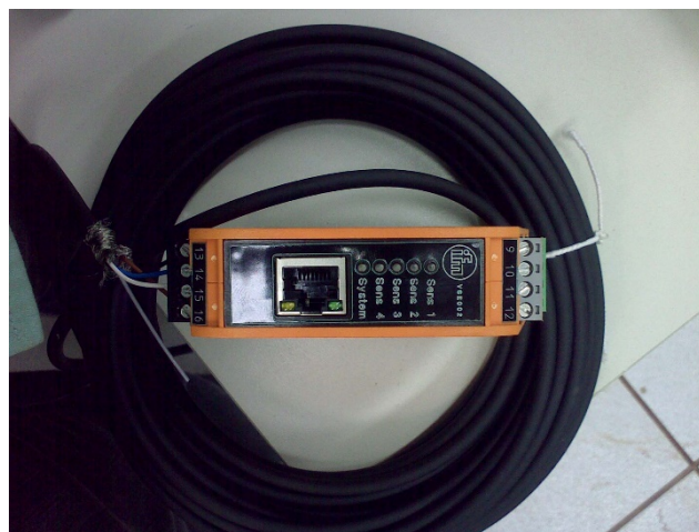
Figura 15 – Ligação dos cabos do acelerômetro em na eletrônica Fonte: VALE, 2016
