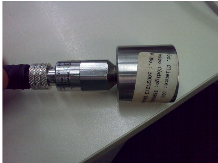
Figura 14 – Base magnética acoplada ao acelerômetro Fonte: VALE, 2016
