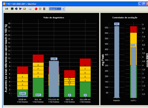
Figura 18 – Tela de alarmes e defeitos contidos no setup da eletrônica Fonte: VALE, 2016
