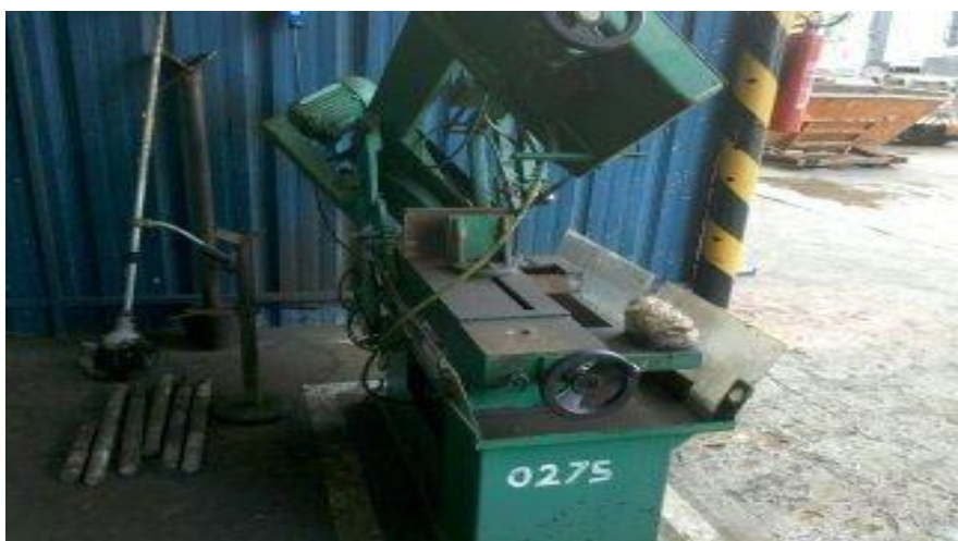
Figura 3. Serra fita sem sistema dessegurança
