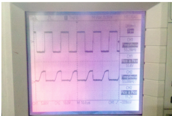
Figura 28 - Resposta do circuito inversor a uma frequência de 53KHz.
