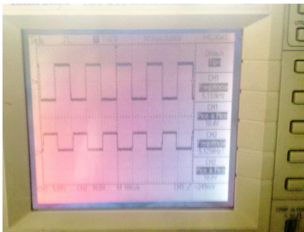
Figura 25 - Resposta do circuito inversor a uma frequência de 5KHz. Fonte: O AUTOR, 2013
