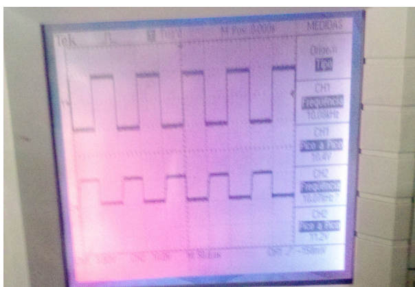
Figura 26 - Resposta do circuito inversor a uma frequência de 10KHz. Fonte: O AUTOR, 2013
