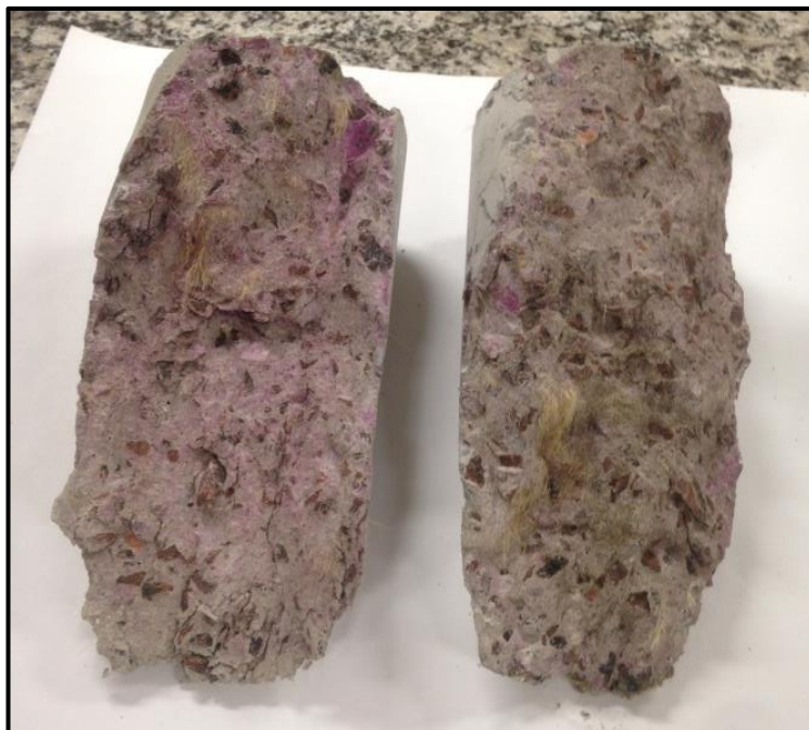
Figura 9: CP's após aplicação do indicador químico de 1% de fenolftaleína. Notam-se as fibras de juta no concreto endurecido.
