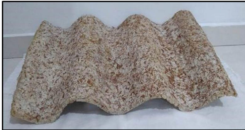
Figura 2: Telha ecológica confeccionada com fibras de coco, papel reciclado e embalagem tetra pak.
