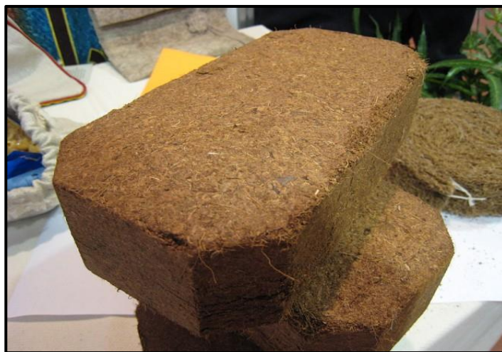
Figura 3: Tijolo confeccionado com fibras vegetais de coco utilizados como paredes, revestimento de pavimentos e etc.
