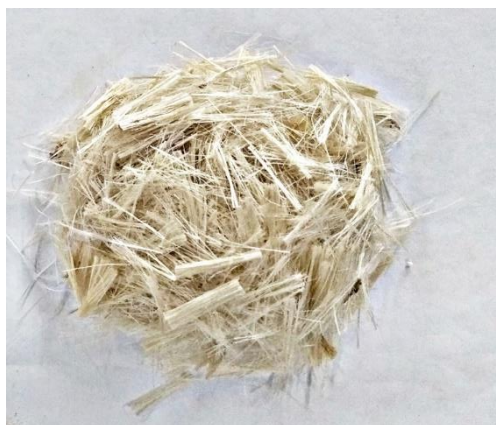
Figura 6: Fibras de Juta cortadas no tamanho 20 mm preparadas para a adição no concreto.
