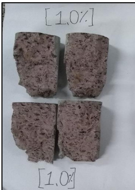
Figura 12: Corpos de prova com 1% de adição das fibras de juta expostos ao ar livre, observados aos 120 dias.
