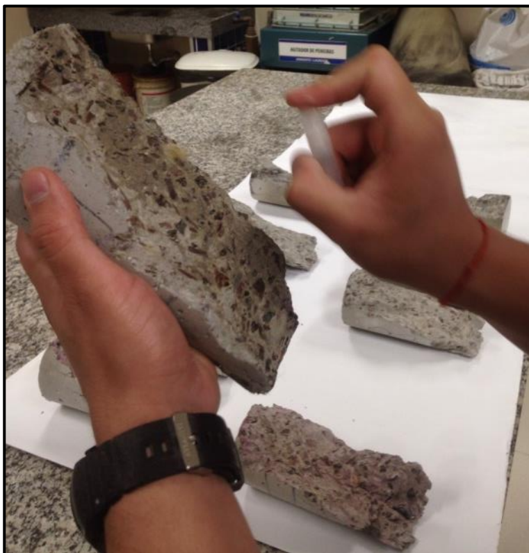
Figura 8: Aplicação do indicador químico de 1% de fenolftaleína com o auxílio de um spray
