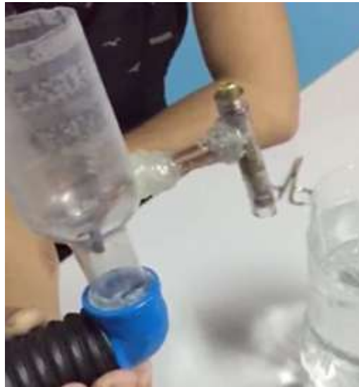
Figura 4- Protótipo de um carburador de garrafa plastica, conexões entre carburador, misturador e gliche. Fonte: AUTORES
