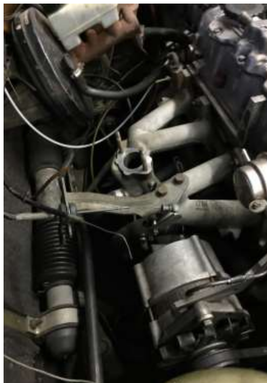
Figura 12 - base do carburador após o uso da lixa. Fonte: AUTORES.
