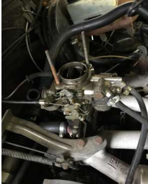
Figura 11 - carburador Weber 190 no lugar. Fonte: AUTORES.
