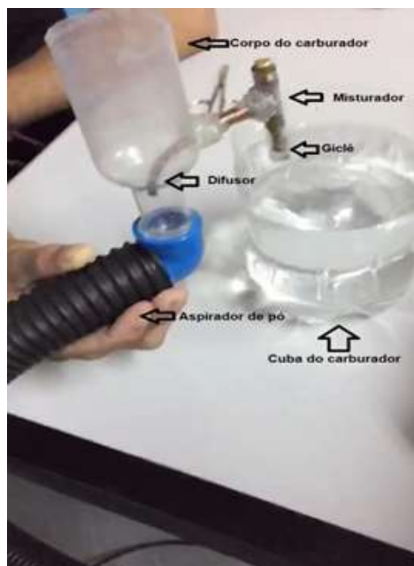
Figura 6- protótipo identificando cada parte do carburador.
