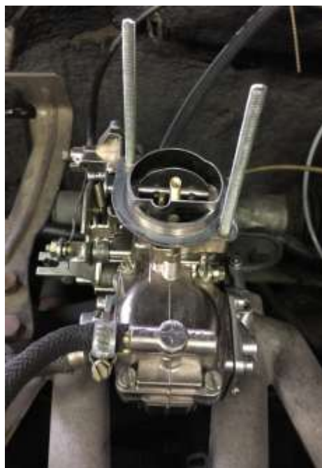
Figura 13 - carburador novo posicionado e com as mangueiras devidamente conectadas.
