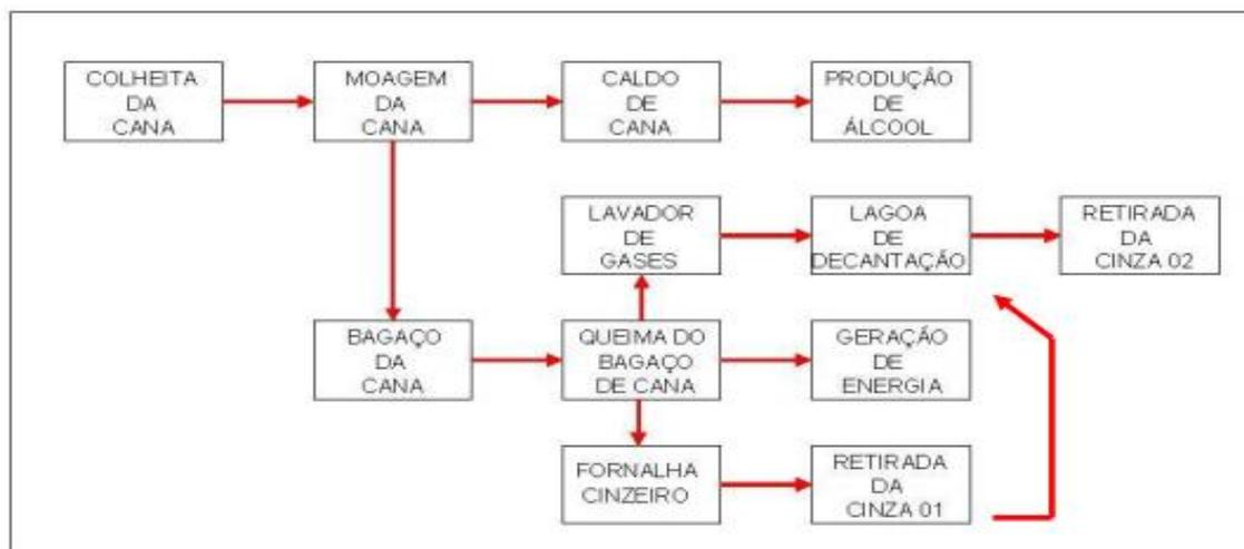
**Figura 02** – Processo simplificado de obtenção das cinzas do bagaço da cana-de-açúcar. Fonte: (Mansaneira, p.44, 2010).
