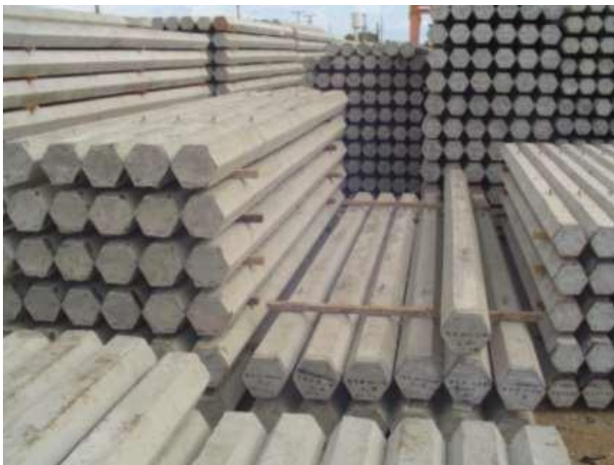
Figura 4 - Estacas de concreto pré-moldada.
