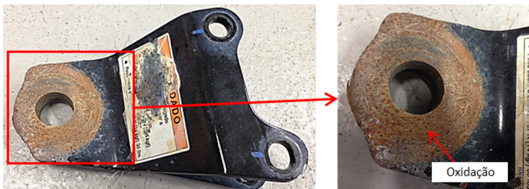
Figura 2: Peça soldada e usada apresentando extensas áreas de oxidação.
