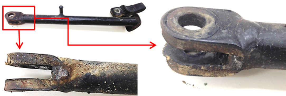
Figura 4: Peça soldada e usada apresentando aderência de poeira, lama e graxa.
