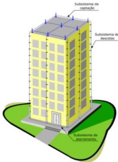
Figura 02: Composição de um SPDA. Fonte: Hélio Sueta (2005).
