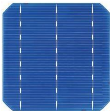
Figura 2 – Célula do tipo monocristalino
