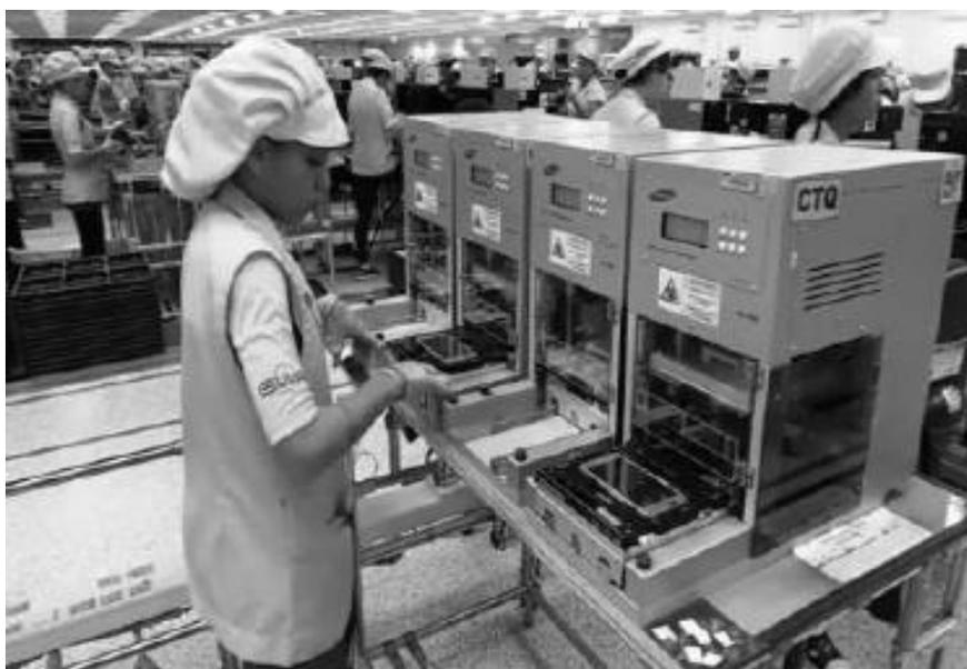
**Figura 5 - Operadora na máquina de prensagem com dois estágio (A e B).**
