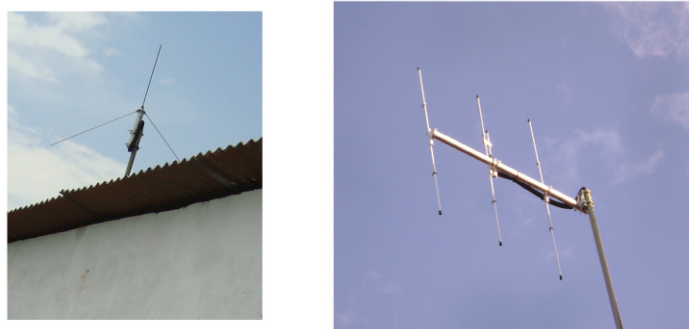
Figura 21. Antenas utilizadas no sistema.
