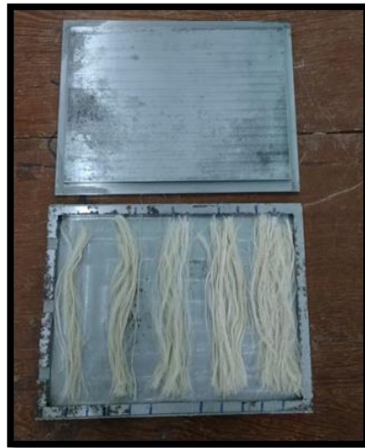
Figura 1: Molde com cavidade e tampa e preparação das fibras no molde.
