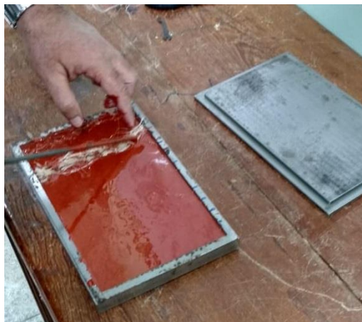
Figura 2: Processo de laminação.
