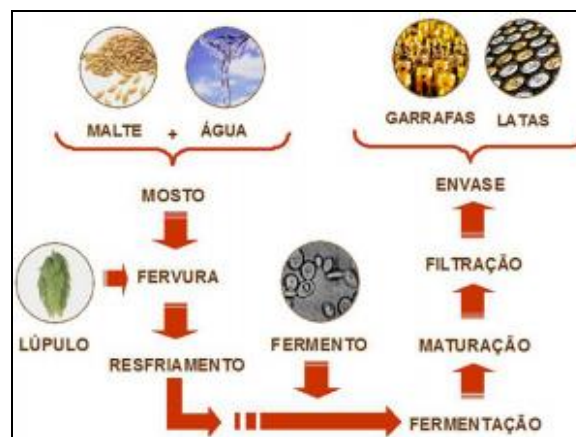
Figura 1- Fluxograma das etapas do processo de fabricação de cerveja.
