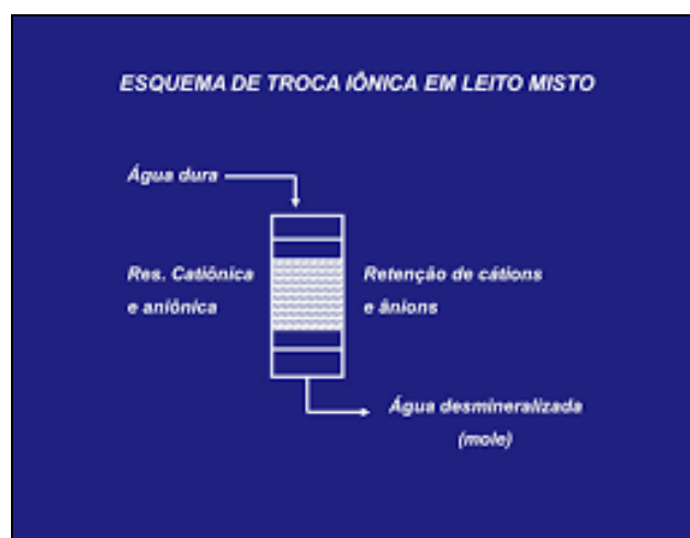
Figura 4- Esquema de funcionamento de uma Resina de troca iônica.
