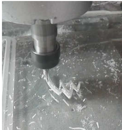
Figura 1: Fresagem com ferramenta de 1 corte Fonte: Próprio autor.
