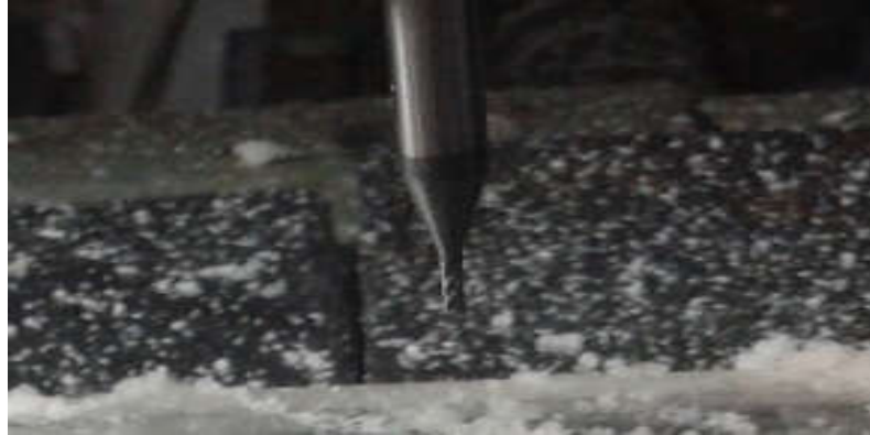
Figura 2. Fresa de metal duro de 4 cortes. Fonte: Autoria própria. Fonte: Próprio Autor
