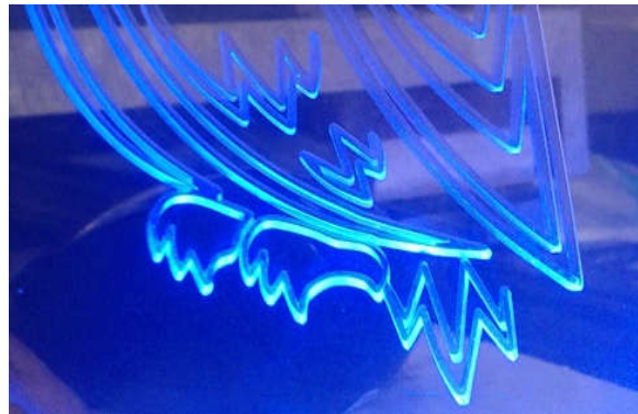
Figura 3. Qualidade da usinagem com fresa de 1 corte em acrílico. Fonte: Autoria própria.
