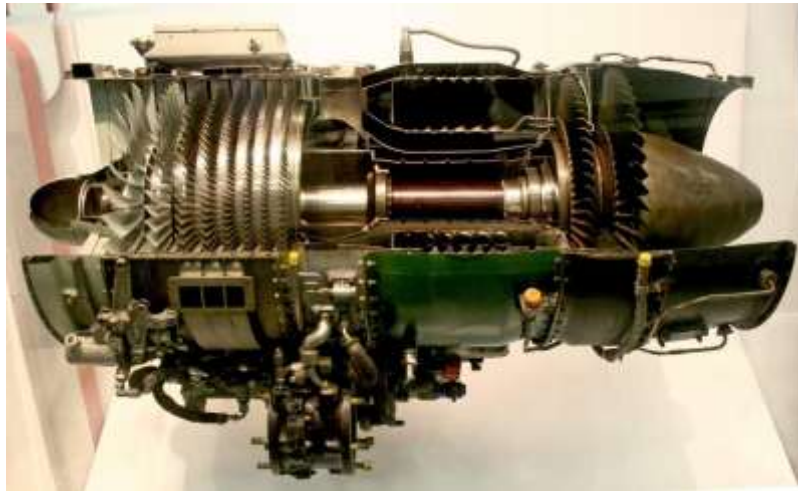
Figura 3. Motor Turbo jato J85/CJ-610 Fonte: ARAUJO; 2017
