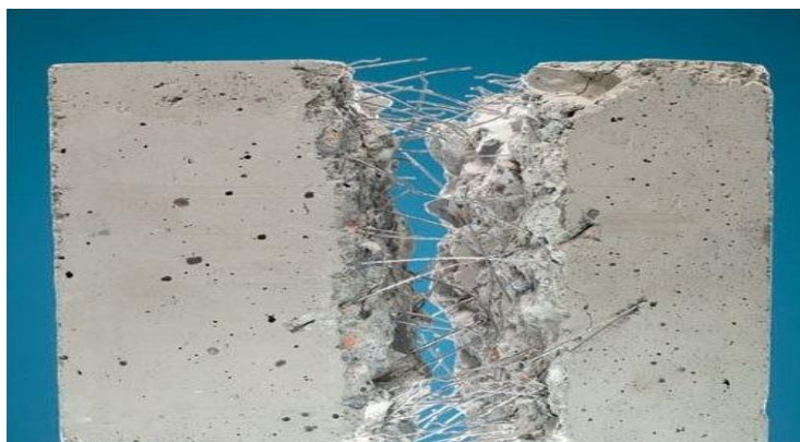
Figura 8- Peça de concreto reforçada com fibras de aço.
