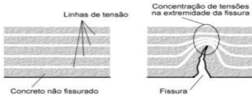
Figura 3 – Esquema da concentração de tensões para concreto com reforço de fibras.
