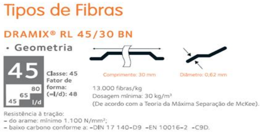
Figura 7 - Característica Fibras de Aço.
