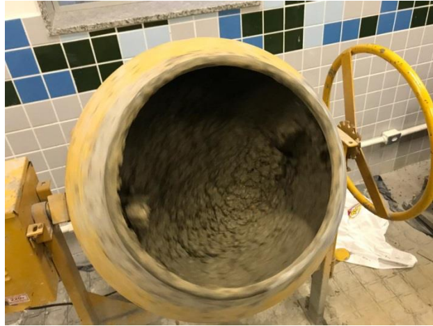
Figura 6: Materiais sendo misturados na betoneira.
