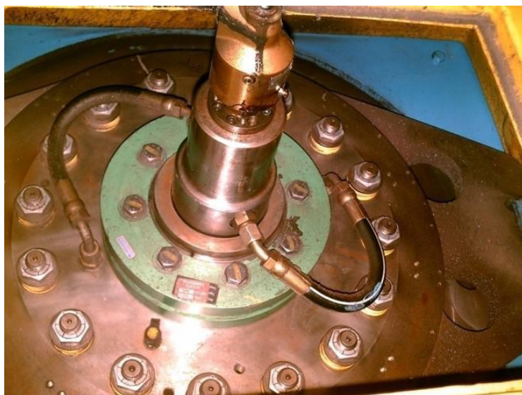
Figura 4 – Sistema de embreagem e freio de uma prensa.
