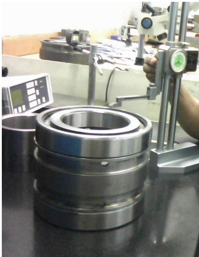
Figura 8 – Medindo a pista externa do rolamento.
