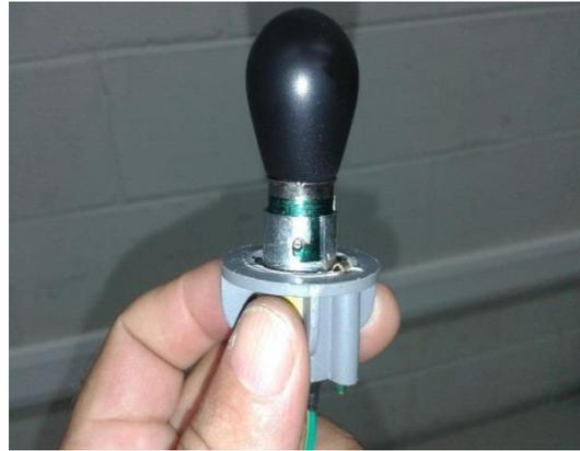
Figura 4 – Lâmpada inserida na base em formato de 'J'.
