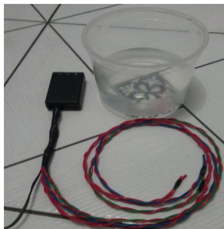
Figura 2: Sensor caseiro projetado para monitorar o nível de água do reservatório. Fonte: Próprio autor.
