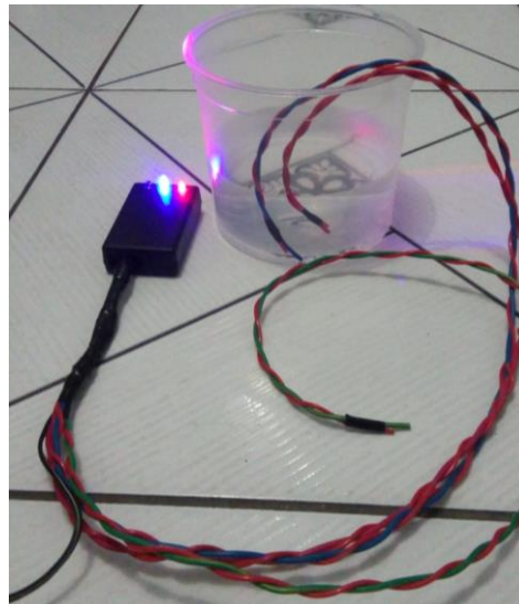
Figura 6: Demonstração da figura 5, apenas os LEDs, azul e vermelho, ligados (estado de atenção do reservatório). Fonte: Próprio autor.
