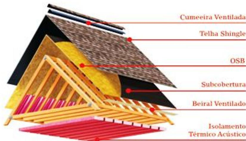
**Figura 3:** Os apoios dos caibros devem ser instalados de 2 à 2,5 metros de cada um, após, é anexado o compensando (OSB) de 10 à 12 mm. No compensando já se encontra a Manta Térmica, para ter sucesso no Isolante Térmico e Acústico, ficando assim, a residência um ambiente com confortável. Por último, anexado também a Subcobertura, Telha Shingle e beiral e cumeeira ventilada.
