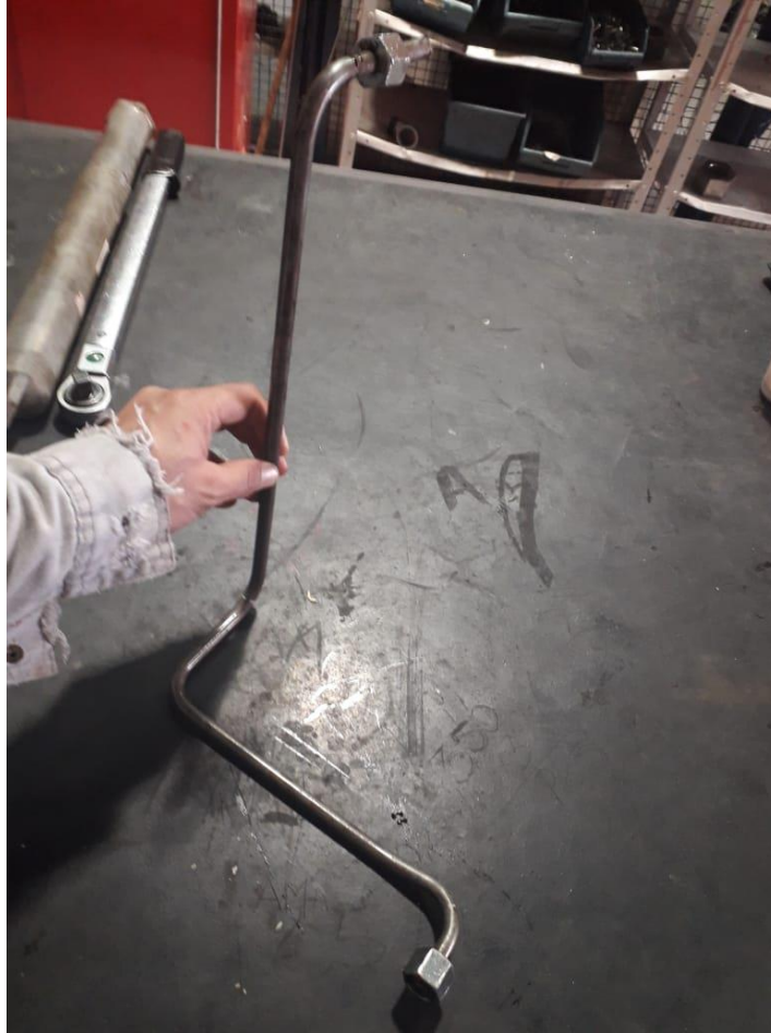
Figura 8: Tubo Pronto após dobramento. Fonte: Próprio Autor, 2018
