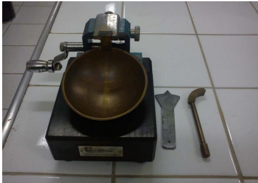
Figura 2: Aparelho de Casagrande. Fonte: Lagetec, 2017.
