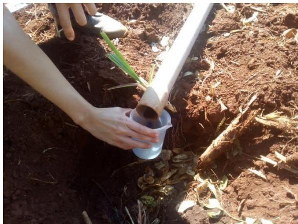
Figura 8 - Procedimento para medir vazão.
