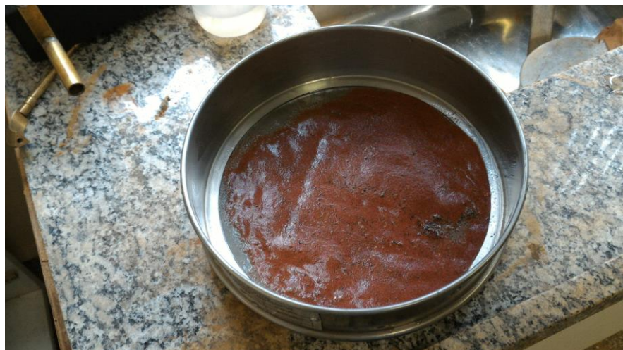
Figura 2 – Lavagem de 120 gramas de solo na peneira 0,075mm. Fonte: O autor.
