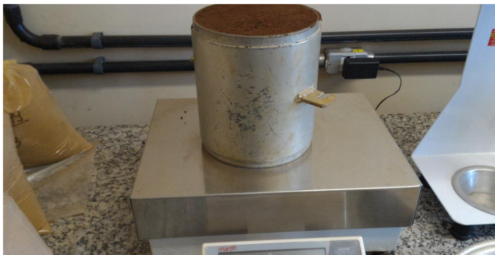
Figura 6 — Pesagem do conjunto solo e cilindro após compactação da amostra.
