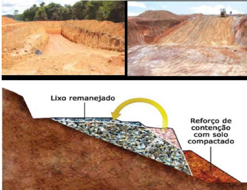
Figura 2. Ilustração de como funciona um aterro controlado. Fonte: FEAM, 2010.
