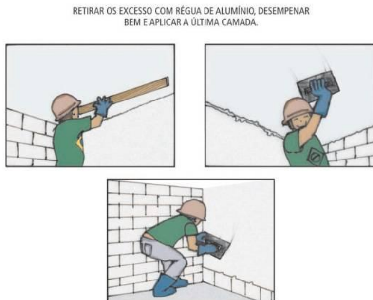
Figura 13: Terceiro Passo do Processo de Desempenamento Fonte: ConstruFácilRJ, 2017
