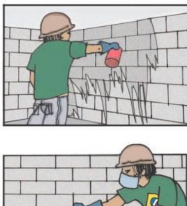
Figura 11: Primeiro Passo do Processo de Desempenamento Fonte: ConstruFácilRJ, 2017
