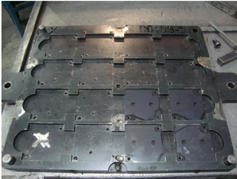
Figura 13 – Dispositivo para confecção de Tampão.
