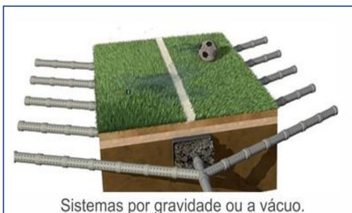
Figura 07: Sistemas por gravidade ou a vácuo. Fonte: Pedreira, 2018.
