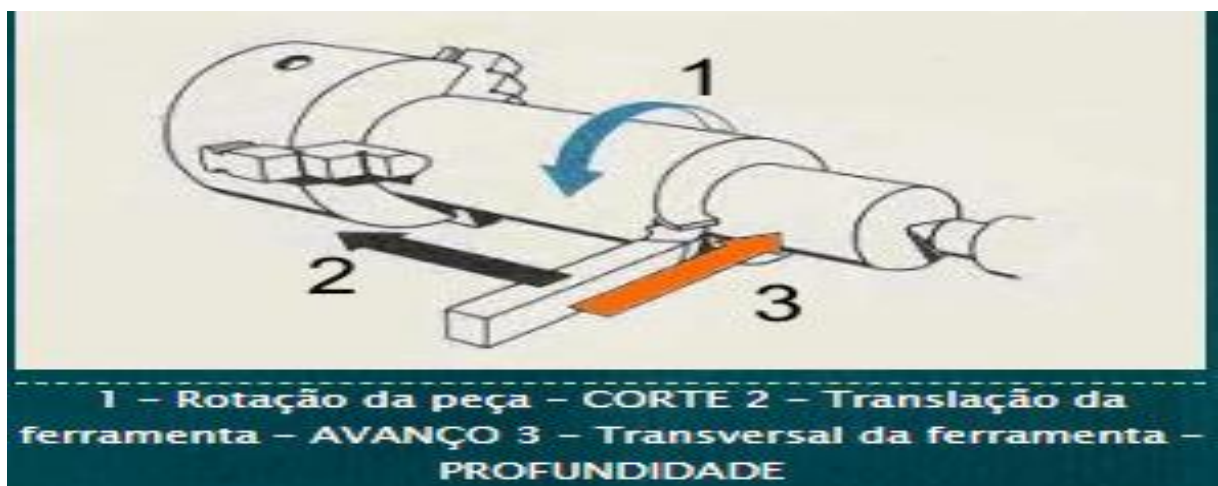
Figura 11 - Ferramenta de torneamento Fonte: mk12more.wordpress (2018).
