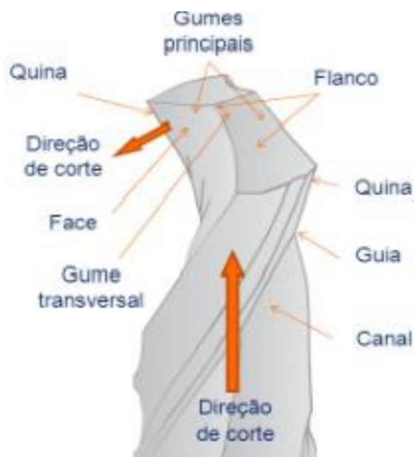
Figura 13 - Ferramenta de corte e canal e sua Geometria. Fonte: https://slideplayer/ <acesso em 20/11/2018, 13:00:>.
