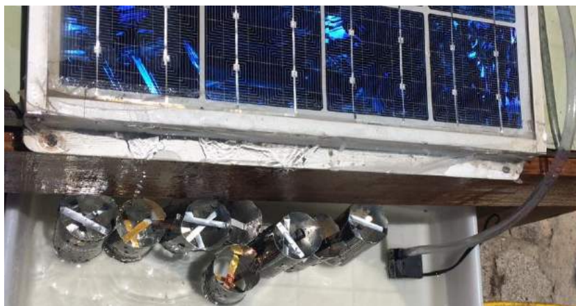
Figura 9: Visão superior das aletas internas do protótipo da torre de resfriamento.
