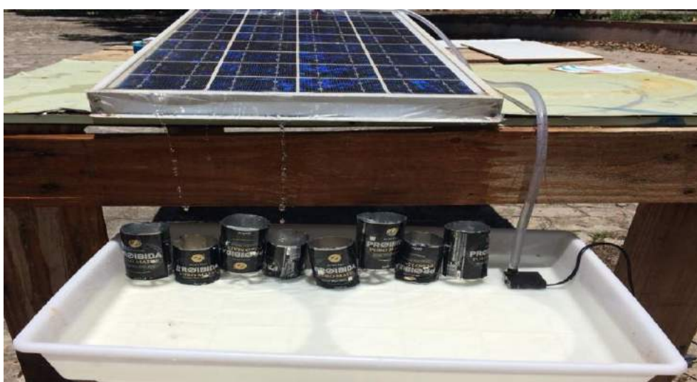
Figura 6: Sistema de resfriamento montado a partir de latas de alumínio reutilizadas.
