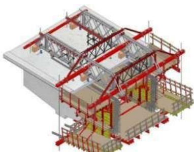
Figura 3: Método de Balanços sucessivos
