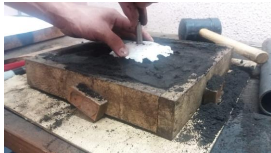
Figura 4 - Ajuste do macho
