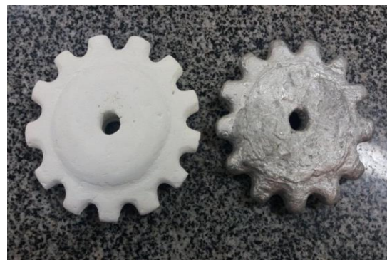
Figura 6 - Modelo de poliestireno (esquerda) e peça fundida de alumínio (direita).
