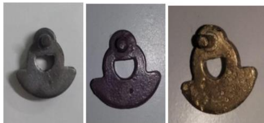
Figura 9 - Primeiro came original, segundo modelo cera e terceiro fundido com latão.
