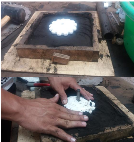
Figura 3 - Ajuste do modelo de poliestireno.
