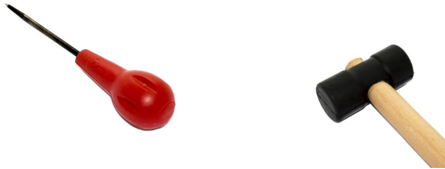
Figura 9. a) sovela utilizada em inspeções visuais; b) martelo auxiliador de inspeções
