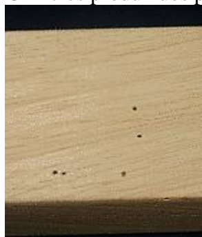
Figura 5: Orifícios produzidos por Brocas
