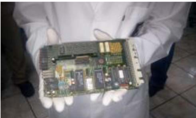
Figura 11 - Correto manuseio do circuito eletrônico
