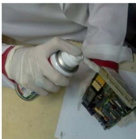
Figura 15 - Este produto remove todas as impurezas e resíduos que prejudicam os contatos e conectores dos circuitos eletrônicos.
