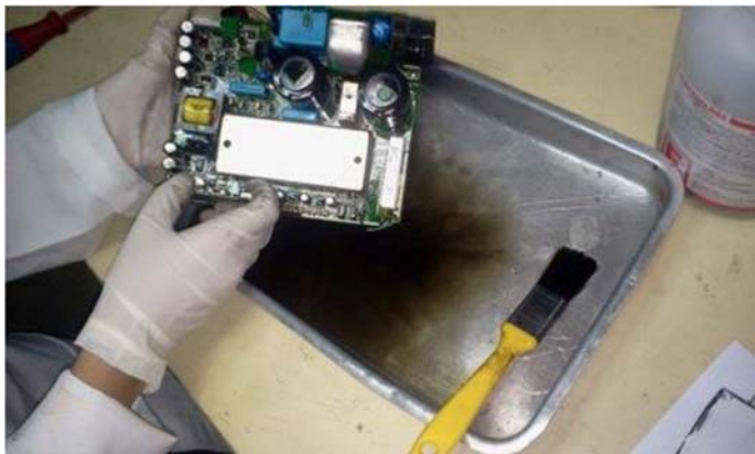
Figura 13 - A coloração escura na bandeja é devido aos resíduos removidos pela ação química do produto.
