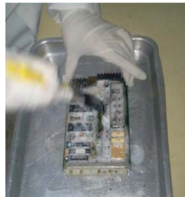
Figura 12 – Aplicação do produto para remoção de contaminantes.
