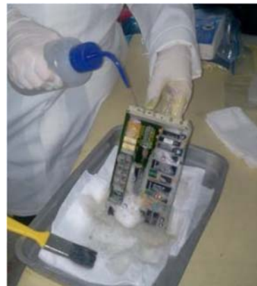
Figura 14 - Enxágüe do circuito eletrônico com água deionizada ou destilada.
