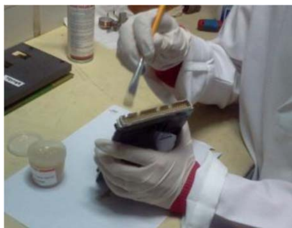
Figura 16 - Aplicação do produto para facilitar a condução de elétrons sem curto circuitar os contatos e lubrificar sem isolar, impedindo a formação do zinabre.
