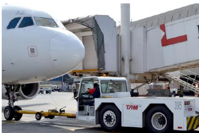
Figura 3: Rebecador Rucker TA-420 acoplado ao trem de pouso de nariz através da barra de push back (barra amarela). Fonte: Catálogo Rucker
