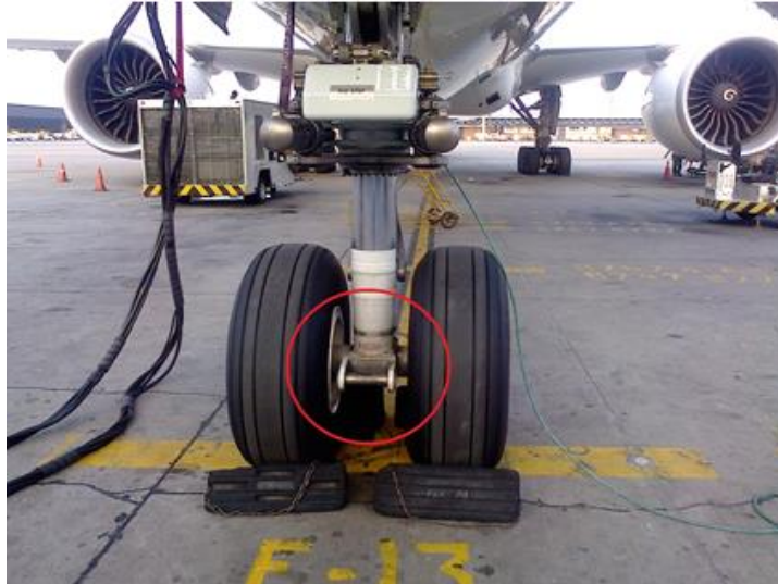
Figura 4 – Pino de acoplamento do trem de pouso para engatar a barra de push back .
