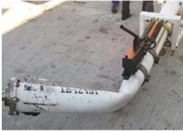
Figura 9 - Representação da barra de push back avariada após o cisalhamento do elemento fusível mecânico. Fonte: Arquivo TAM, 2015.
