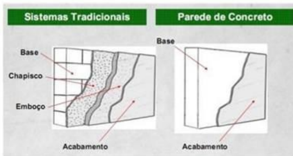
Figura 14 – comparativo entre o sistema tradicional e o sistema moldado.
