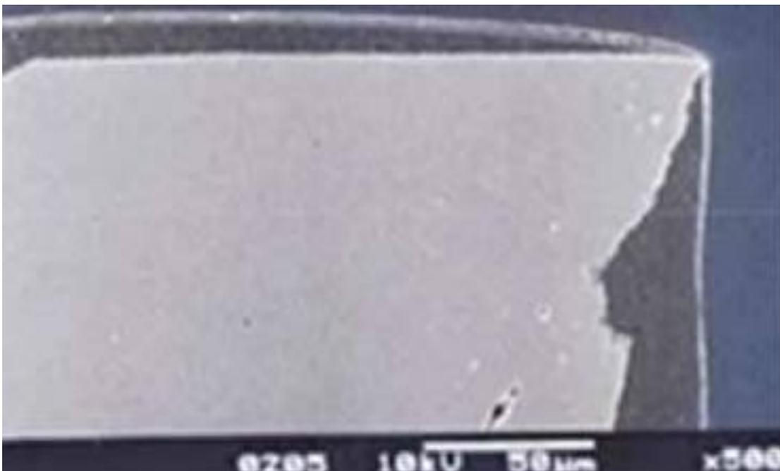
Figura 2. Revestimento orgânico eletrodepositado sobre chapa de aço carbono – borda com falhas de cobertura.
